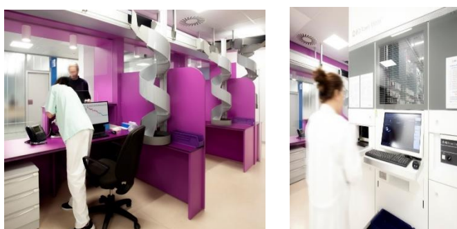
Imagen 12 y 13. Puesto de trabajo del técnico de farmacia: diseñado para minimizar los desplazamientos y tolv de dispensación conectada al Robot ROWA®.
